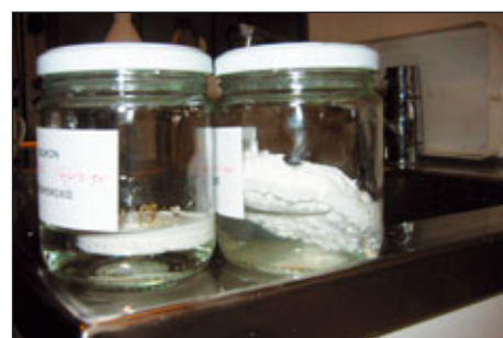
Test chemické odolnosti tmelu
