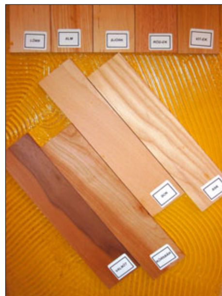
Zkouška přidržitosti MS-polymerového lepidla pro dřevěné krytiny
